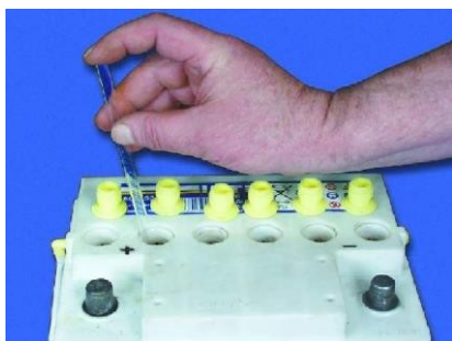
Рис 2. Проверка уровня электролита
