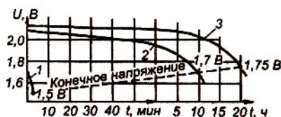
Рис. 9. Разрядные характеристики аккумулятора при различной силе разрядного тока и температуре электролита +25\text{ }^{\circ}\text{C} : 1 — 5-минутный режим разрядки силой тока 0,25C_{20} , I_p = 240\text{ A} , C_p = 20\text{ A} ; 2 - 10-часовой режим разрядки силой тока 0,87C_{20} , I_p = 7\text{ A} , C_p = 70\text{ A} ; 3 — 20-часовой режим разрядки силой тока C_{20} . I_p = 4\text{ A} , C_p = 80\text{ A}
