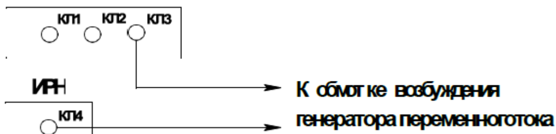
Рисунок 15 Схема подключения обмотки возбуждения генератора.
