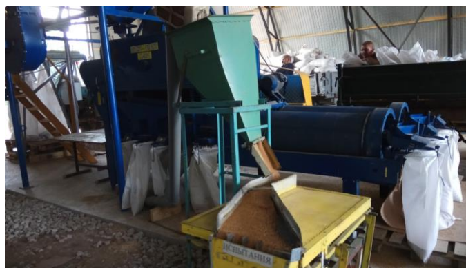
Рис.2. Экспериментальный вибропневмосепаратор семян в составе линии послеуборочной обработки семян
