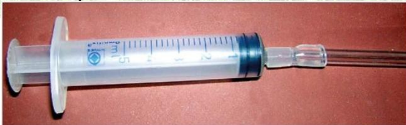
Соединение полистироловой пипетки со шприцем
