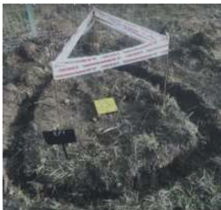
Рисунок 2 – Опознавательный знак с известными координатами
