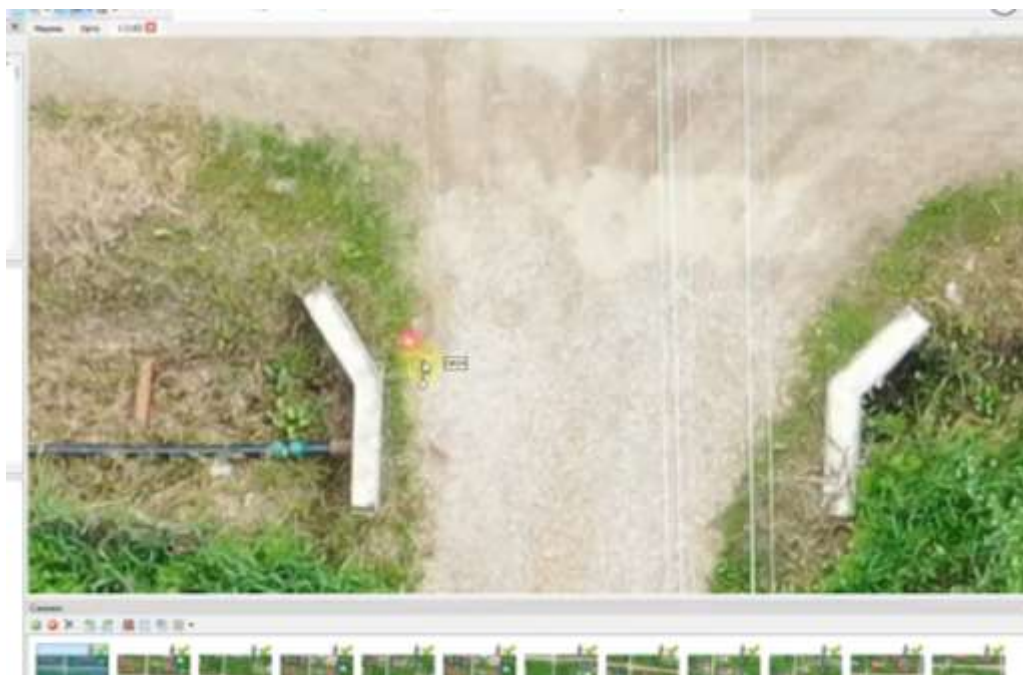
Рисунок 17 - Совмещение опознавательных знаков со знаками на фотографиях
